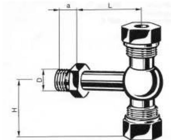
Type 142865: Zwischenhalter mit Gewindeanschluss
